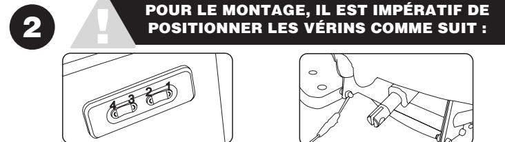
Interrupteurs de contrôle : 1 et 2: repose-pieds; 3 et 4: dossier
