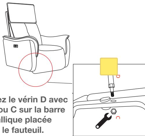
Vissez le vérin D avec l'écrou C sur la barre métallique placée sous le fauteuil.
